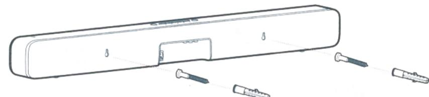
Просверлите на основе поставленных точек два отверстия в стене, в зависимости от типа вашей стены сложно процедуру может меняться.
