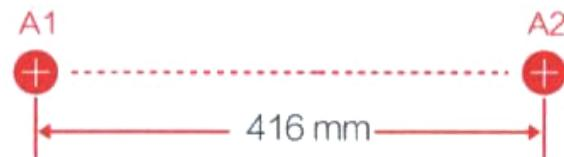
Выберите точку A1 на стене, в соответствии с пожеланием расположения аудиосистемы. Проведите линии в соответствие с уровнем, и на расстояние 416мм справа отметьте точку A2.
