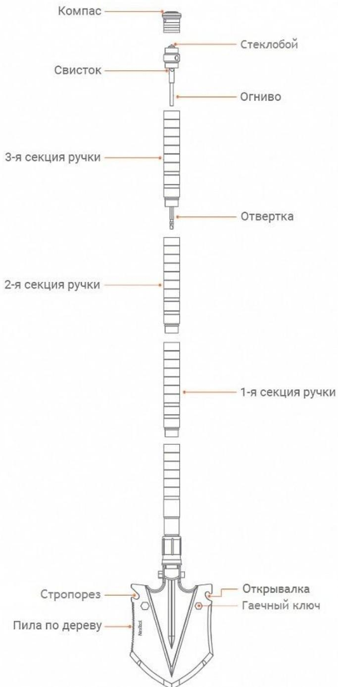
На основном рабочем полотне лопаты расположены пила, топор, стропорез, гаечный ключ. Компас расположен на торце рукоятки лопаты. При складывании рабочего полотна лопату можно использовать как мотыгу или ледоруб. При использовании ледоруба рекомендуется установить на рукоятку хвостовик со шнуром и набросить шнурок на руку.
