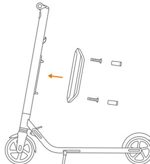
2. Установите рейку с помощью болтов M4 (10 мм) (3 шт.), прилагаемых к данному изделию. Пожалуйста, убедитесь, что она зафиксирована.
