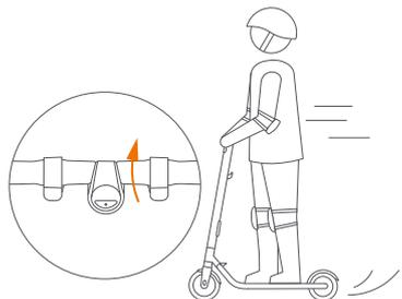
4. Сбавьте скорость, отпустив рычаг газа; быстро переместите рычаг тормоза и одновременно наступите на крыло ногой, чтобы активировать механическое торможение и резко остановиться.
