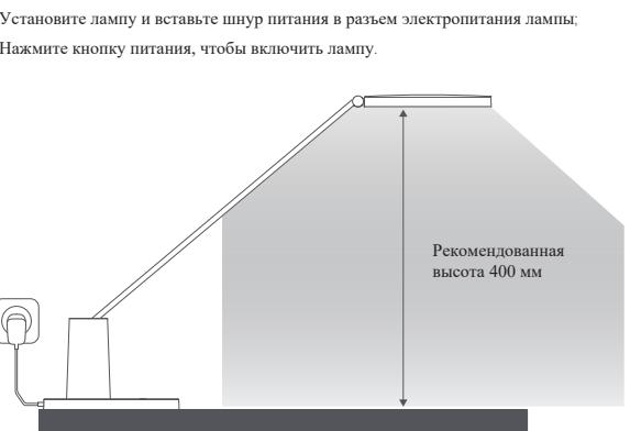
Применение: Использовать в помещениях. Настольная лампа находится в нормальном рабочем положении, направление АВ параллельно с поверхностью рабочего стола. Вертикальное расстояние между поверхностью выхода света и рабочим столом составляет 400 мм.
