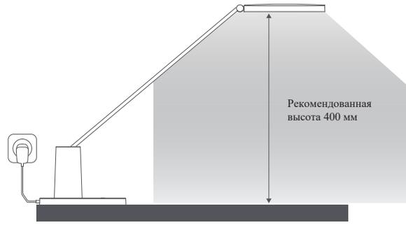
Применение: Использовать в помещении. Настольная лампа находится в нормальном рабочем положении, направление АВ параллельно с поверхностью рабочего стола. Вертикальное расстояние между поверхностью выхода света и рабочим столом составляет 400 мм.
