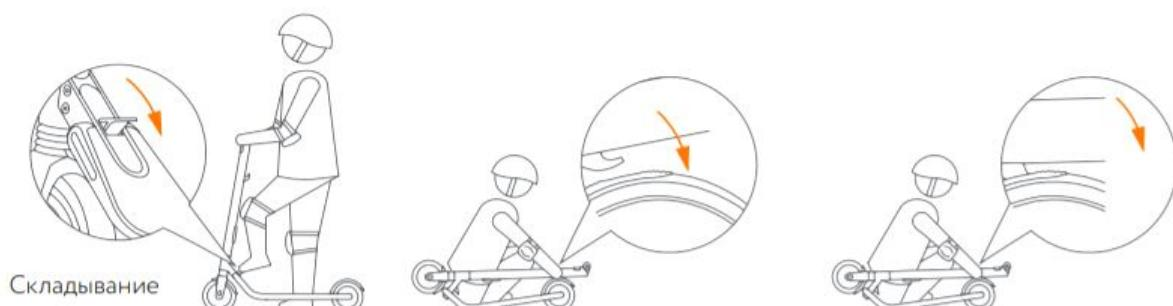
Наступите на язычок фиксирующего механизма и слегка надавите на руль вперед. После этого сложите руль в направлении заднего крыла. В сложенном виде самокат можно переносить, удерживая за рулевую стойку.
